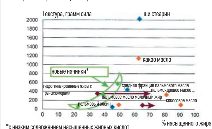
Рисунок 1. Анализы текстуры на текстурометре (TX2i) с использованием иглы P/2N после хранения при 20°C. Глубина проникновения 5 мм.
